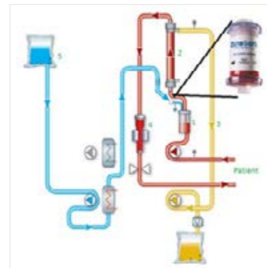
Abb. 1: Installation des CytoSorb Adsorbers mittig in das arterielle zuführende Schlauchsystem und vor dem KitPaed-Filter. (1) Luftfalle (2) KitPaed Filter (S—0.2 m2). (3) Ultrafiltrations-Schlauchsystem. (4) Luftfalle. (5) Substitutat. CytoSorb wurde vor dem Filter (2) installiert. Ersatzflüssigkeit wurde als Prädilution gegeben, hinter der Luftfalle (1), vor CytoSorb Installation.
